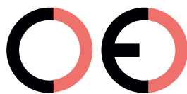
Faux marquage CE (trop éloigné)
